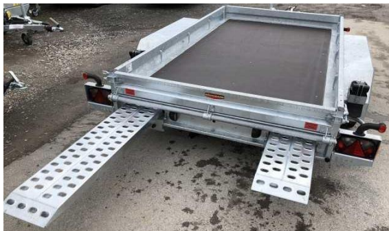
Stahlrampen in Rampenschacht
