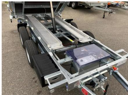
Rampen in Rampenfach Kurbelstütze
