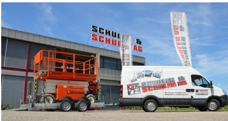
Scherenbühne mit Eigengewicht von 2700kg auf Absenker FB 35.35, 345 x 162 x 10cm GG 3500kg mit Alurampe
