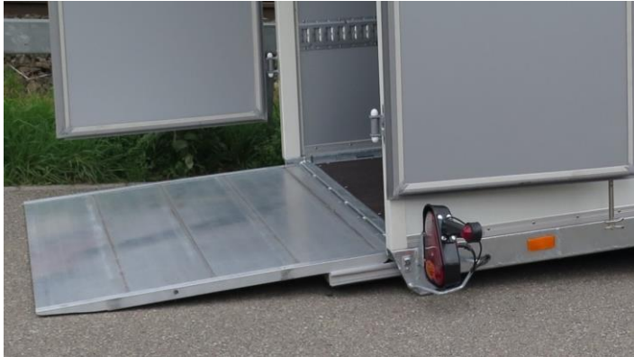
Rampe in Sonderausführung, Traglast 1200kg mit Anfahrspitz (Mehrpreis)
