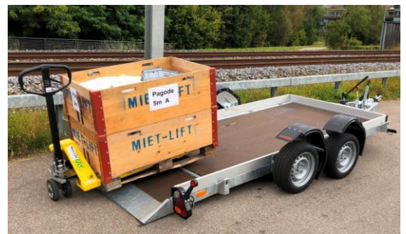
Scherenbühne mit Eigengewicht von 2700kg auf Absenker FB 35.35, 345 x 162 x 10cm GG 3500kg mit Alurampe
