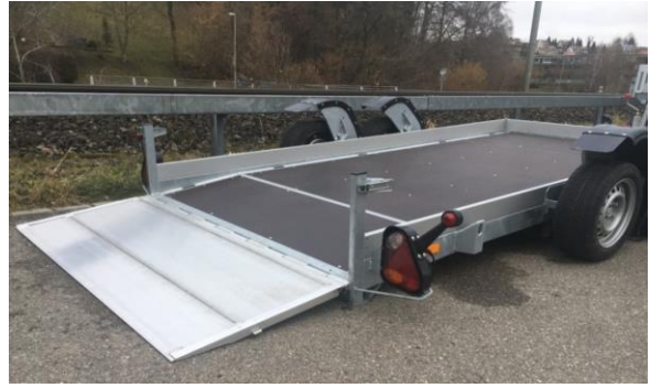
Boden hinten angeschrägt, 60cm Aluminiumrampe 1000kg belastbar, Boden verstärkt für Beladung von Kleinstapler
