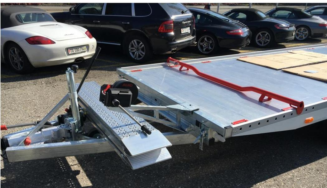
**Handseilwinde seitlich verstellbar, Radanschlagstange**
