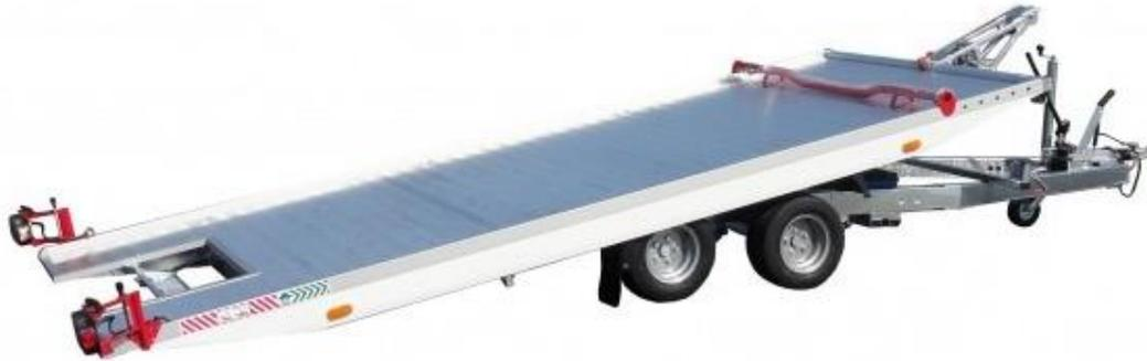
**Imola 35.47, 474 x 209cm, abkipbare Brücke mit Aluminiumprofilboden, Handseilwinde**
