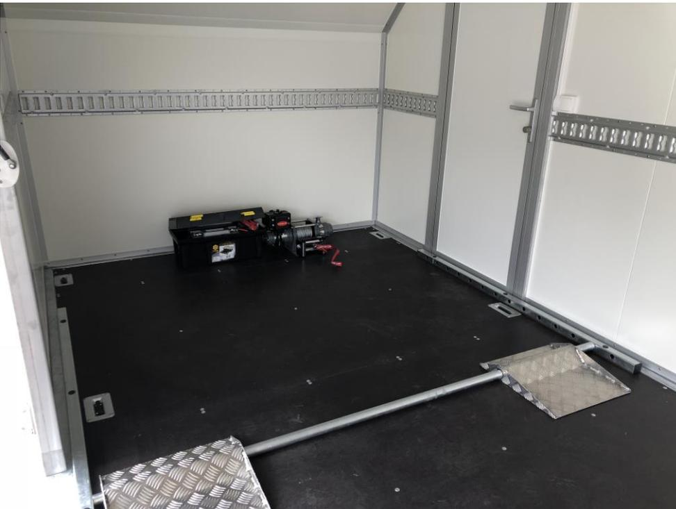
**Elektro-Seilwinde, Radanschlagstange, Loch-Schlitzzurrschienen, Seitentüre**
