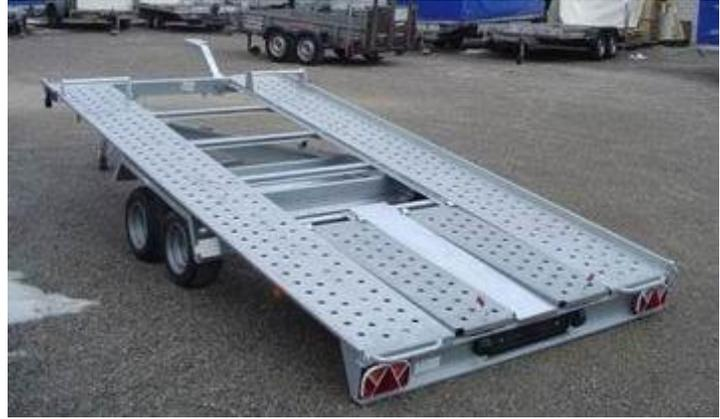
Autotransportanhänger mit Kippbrücke, Ein- oder Tandemachser, Gummifederachsen wartungsfrei, Auflaufbremsen mit Rückfahrautomatik, 50mm Kugelkupplung, Stützrad, Radkeile, Bereifung 195/55 R10C, Brücke kippt durch Gewichtsverlagerung, hinten zwei Auffahrrampen gelagert, Fahrgestell und Aufbau verzinkt. Lochschiene für das Einhängen von Hakengurte, 2 Radstopper, vorne Halter für Ersatzrad und Handseilwinde, Beleuchtung 12V im Lichtbalken geschützt mit 13poligem Stecker.
