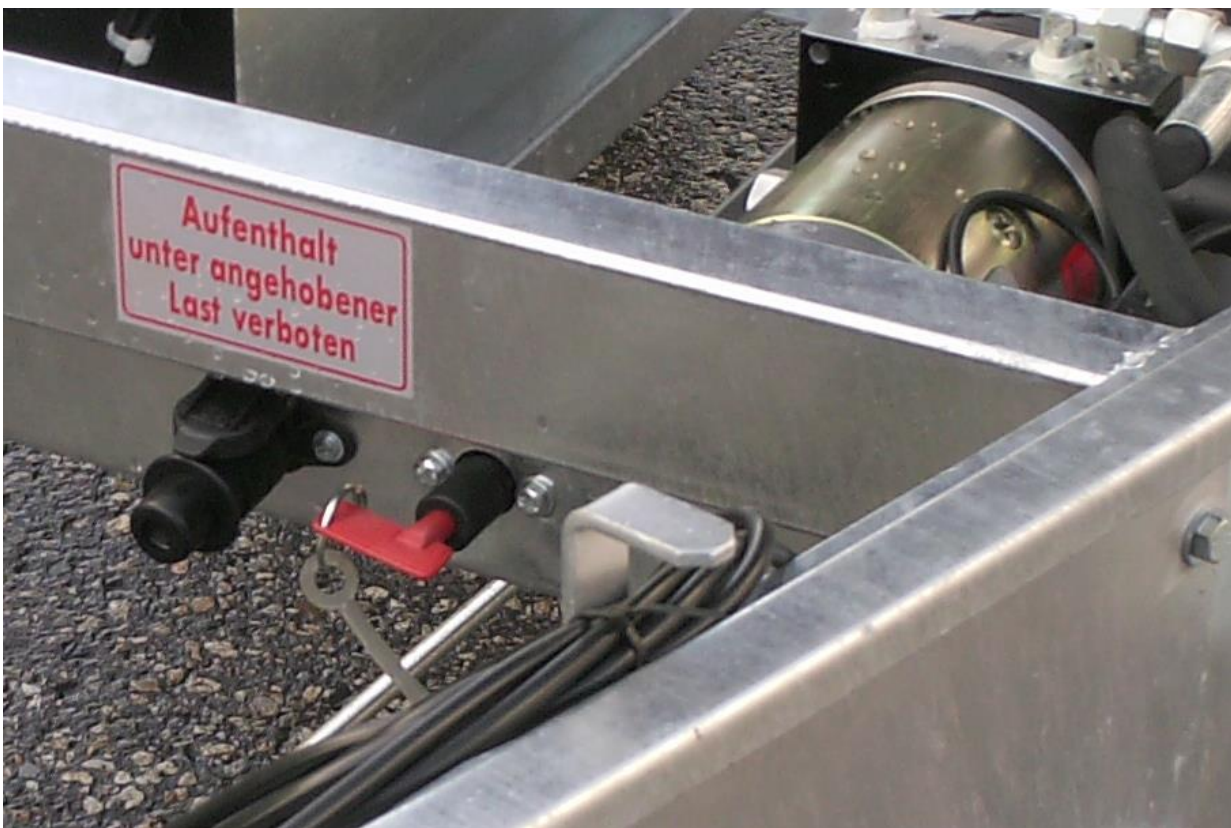
Steckdose für externes Ladegerät (rechts), Stromunterbruch-Schalter (rechts)
