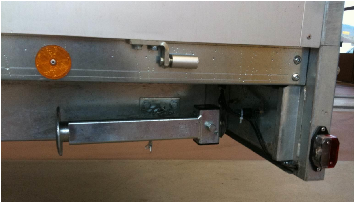
Abdrehbare Kurbelstützen seitlich am Längsträger angebracht
