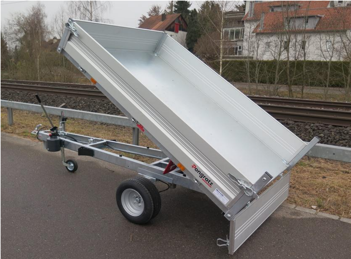
L-RK 2715 G, 267 x 151 x 30cm, leichter Rückwärtskipper, Handpumpe
