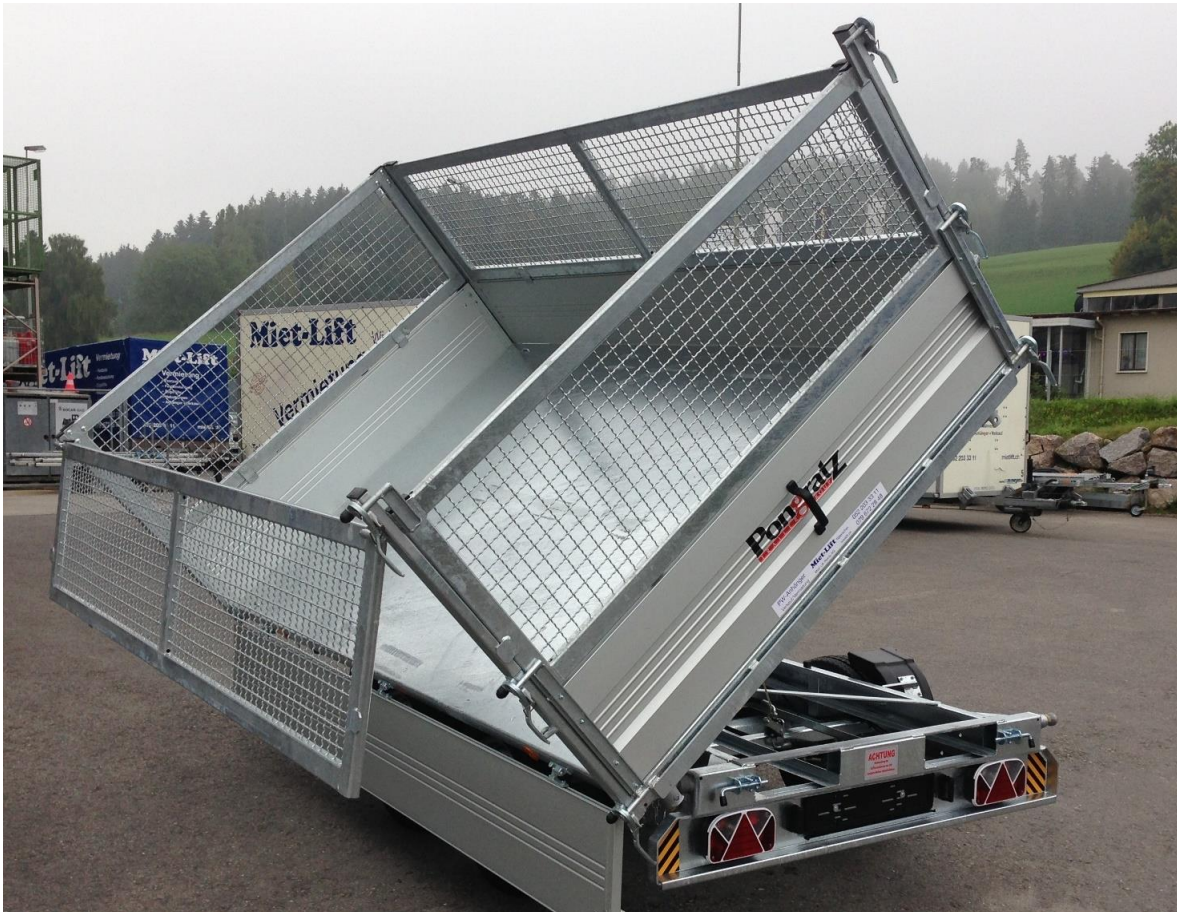
Laubgitter 3-seitig auspendelbar, integrierter Rampenschacht über Lichtbalken
