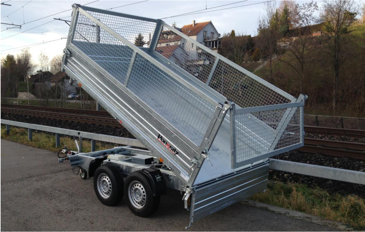
3-Seitenkipper, 310 x 176 x 40cm, 3mm Stahlboden, Stahlwände 40cm und Laubgitter 62cm Verschweisst und feuerverzinkt
