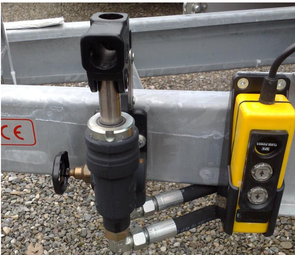
Kabelbedienung für Kipphydraulik, Not-Handpumpe
