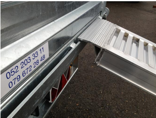
Aluauffharrampen für 3-SKS, Hakenende für das Einhängen im Nutprofile am Brückenende
