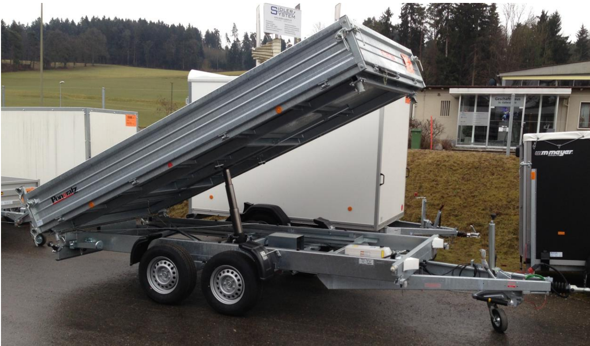
3-Seitenkipper, 410 x 206 x 40cm, 3mm Stahlboden, GG 3500kg
