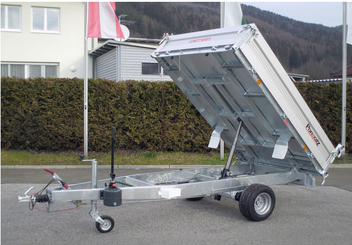
RK 2600/15 G, 260 x 151 x 36cm, starker Rückwärtskipper, Handpumpe Alu- oder Stahlwände
