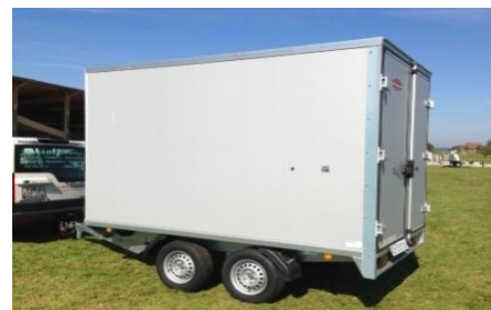
KH Hochlader Plywoodwände, Alu- oder Sandwichdach
