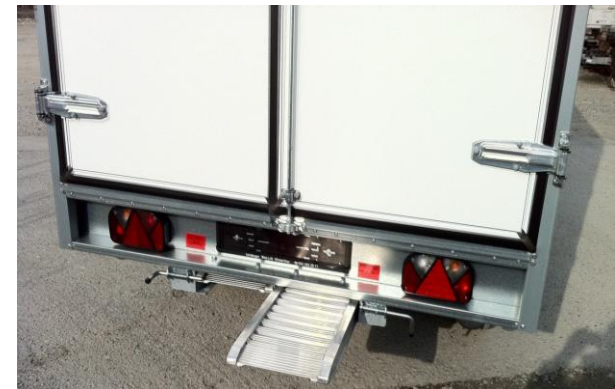
Aluminium-Auffahrampen in Rampenschacht
