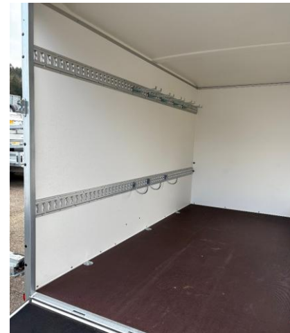
Werkzeuganhänger mit Rampe, Seitenklappe, Schienen und Werkzeughalter, Karettenhalter, Lagergestell Würth, Tablare Weitere Möglichkeiten mit Trennwand und Seitentüre für Büro/Pausenraum mit Fenster und Tisch/Bank
