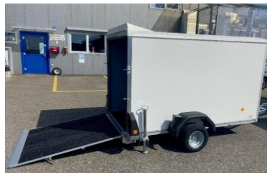
KT 2513/135 mit Kombirampe Plywoodwände, Niederfahrwerk 10" statt 13" Räder ca. 35cm Ladehöhe, flacher Rampenwinkel
