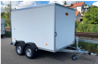
KT Plywoodwände Polyesterdach Flügeltüren
