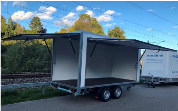
KH 3221 mit Niederfahrwerk, 2 Ausstellklappen
