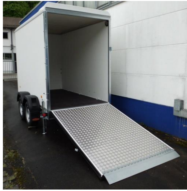
KT 3015/H Rampe mit Aluriffelblech
