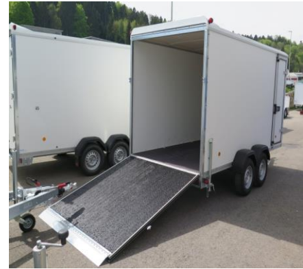
KT 4018/H Rampe mit Silikonbeschichtung
