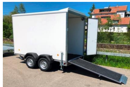
KT RT Plywoodwände, Polyesterdach eine Hälfte Türe, andere Hälfte Rampe
