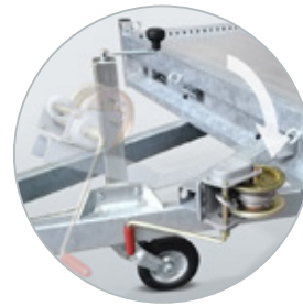
Längenverstellbare und neigbare Winde
