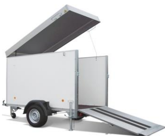
KT-2513/135K Plywoodwände, Aludach hochklappbar, Rampe mit Antirutschbelag
