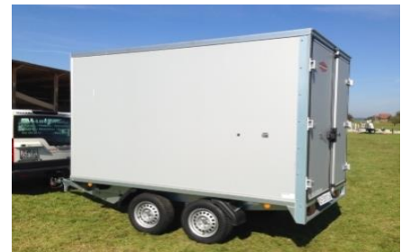
KH Hochlader Plywoodwände, Alu- oder Sandwichdach
