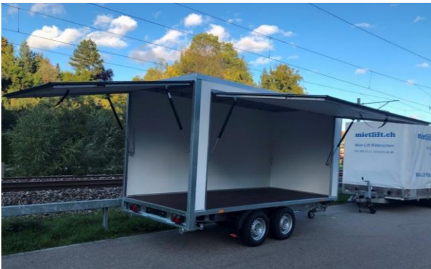
KH 3221 mit Niederfahrwerk, 2 Ausstellklappen
