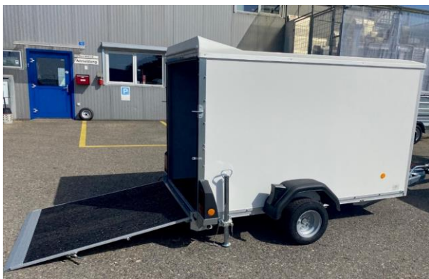
KT-2513/135 F Niederfahrwerk 10"-Bereifung, Kombirampe, Ladehöhe ca. 35cm
