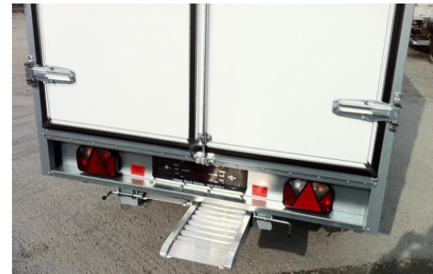
Aluminium-Auffahrampen in Rampenschacht
