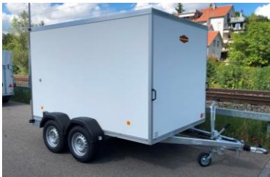
KT Plywoodwände Polyesterdach Flügeltüren
