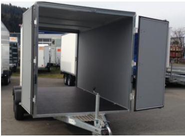
Fronttüren für das Durchladen zum Fahrzeug
