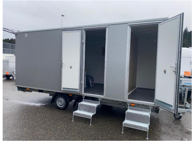
Mobi 5600 mit leerem Werkzeugteil, Länge 1m. Inkl. Beleuchtung und Steckdosen, separate Türe
