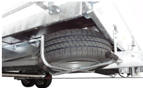
Ersatzrad unter Brücke montiert
