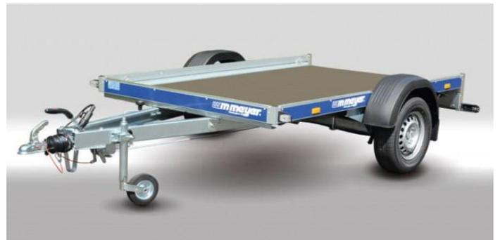
**Motorradanhänger**, robuster verzinkter Unterbau, 2 Motorradstandschiene, 1 Auffahrschiene (3.Standschiene kann erweitert werden). 750kg ungebremst oder 1000kg mit Auflaufbremsen und Rückfahrautomatik. Stützrad, Aluminiumbordwand 10cm mit verstellbaren Bindeplatten. Siebdruckholz- boden oder Siebdruckboden mit Aluriffelblech belegt. Beleuchtung 12 Volt mit 13-poligem Stecker. **Für 100km/h zugelassen**
