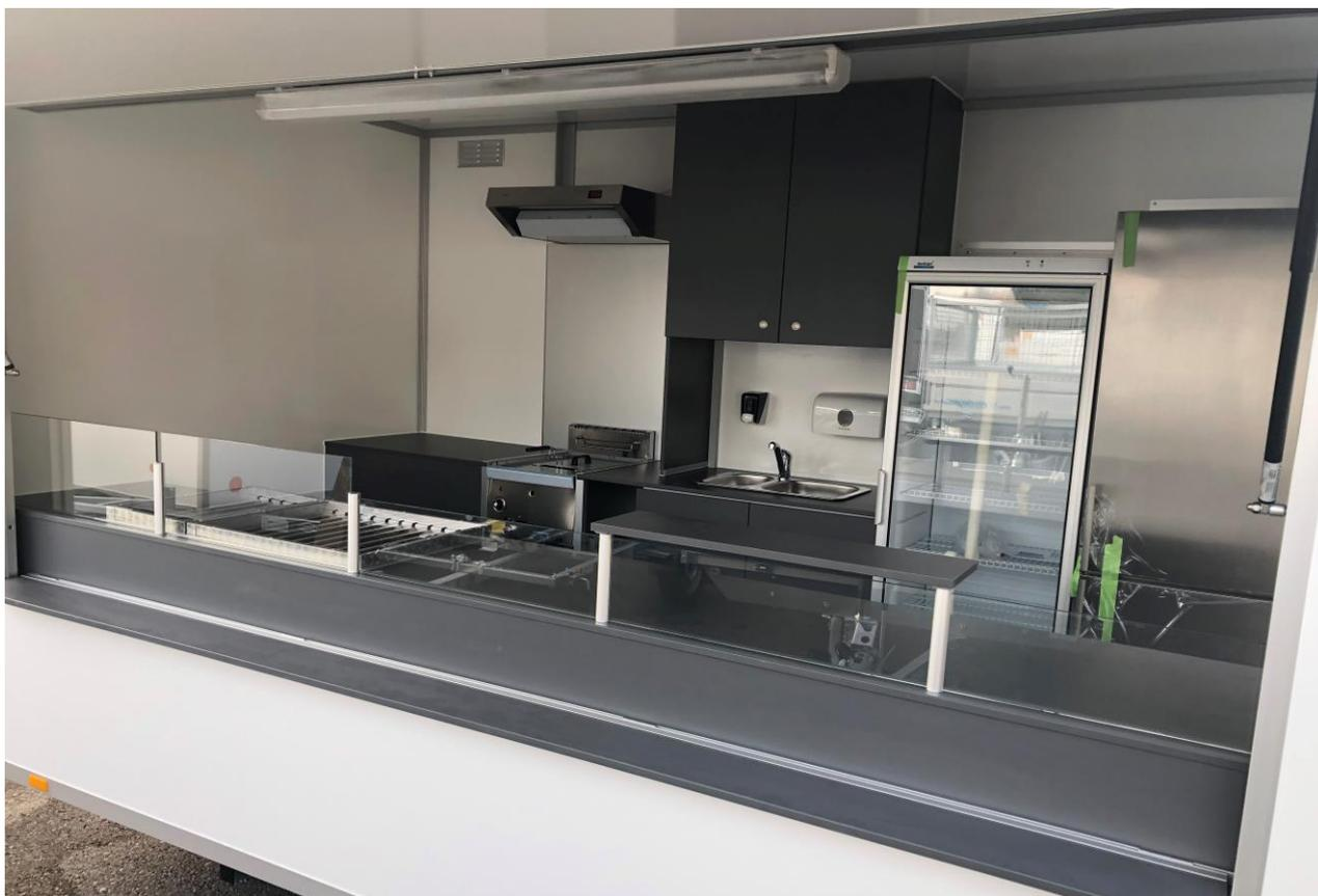
**VKE 1337/206 2 Gasgrill, Spuckschutz auf ganzer Länge, Übergabetablar. Gaskasten, Gasfriteuse mit Dampfabzug und Hitzeschutz an Wand. Waschbecken mit Ober- und Unterschrank, Heisswasserboiler, Getränkekühlschrank mit Glastüre, Kombischrank kühlen/gefrieren, Neonlampe über Verkaufstheke. Decor anthrazit**
