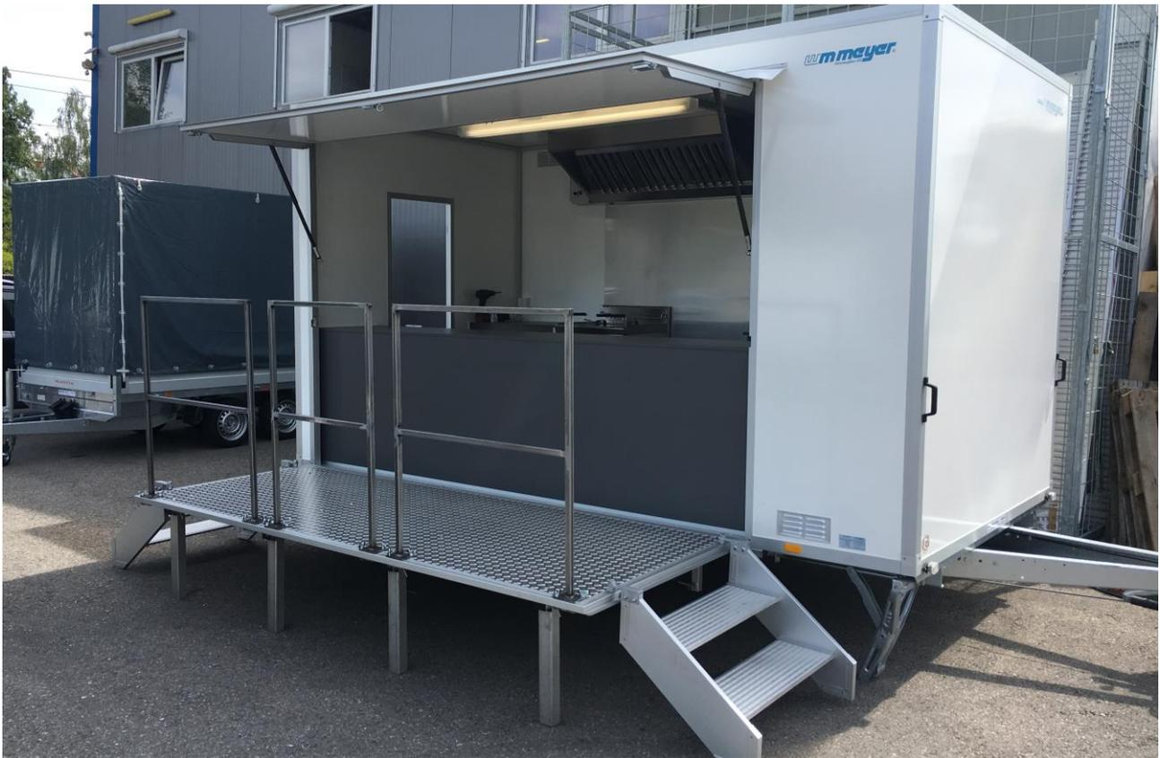
**Hochlader mit abklappbarem Podest, Treppen und Schutzgeländer in verschiedenen Positionen aufbaubar**
