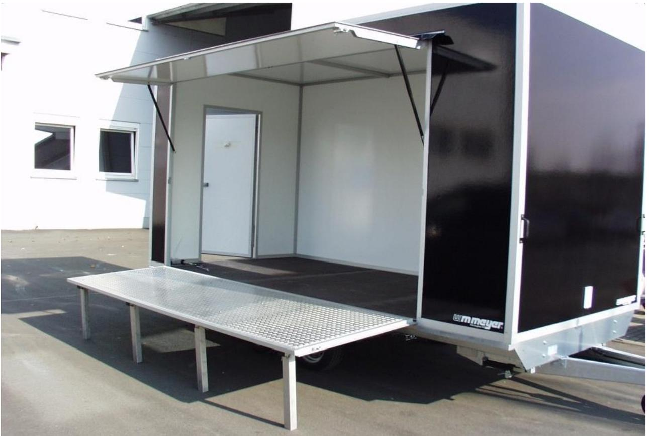
**Hochlader Demo-Anhänger mit abklappbarem Podest und Klappe nach oben aufgehend**
