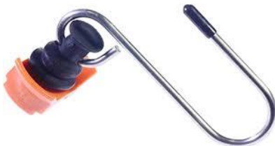
Zurrschlag Airline mit Bügel, orange orange Alu-Zurrschiene (Airline). Hakenhöhe 100mm, Öffnung 25mm
