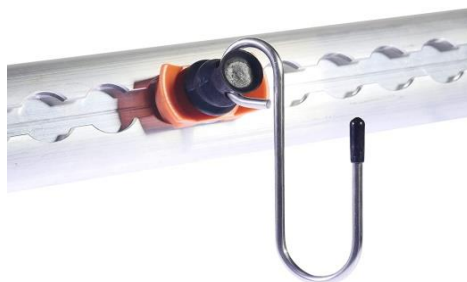
Zurrschlag Airline mit Bügel, orange orange Alu-Zurrschiene (Airline). Hakenhöhe 100mm, Öffnung 25mm
