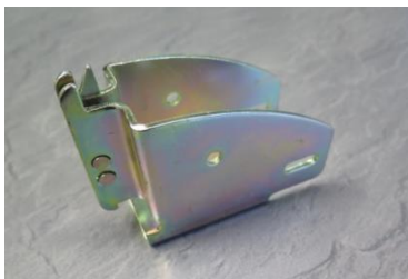
Balkenschuh zu Loch-Schlitzschiene Nr. 58100, Stahl verzinkt Innenbreite 43mm, Innenhöhe 70mm Innenmass Ausladung 86mm Miet-Lift Art.Nr. 58114
