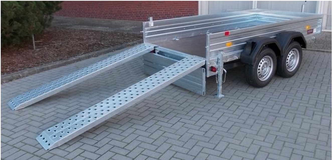
TL-ST 3015/35 AU, Stahlrampen unten einschiebbar, verstärkte Schiebestützen
