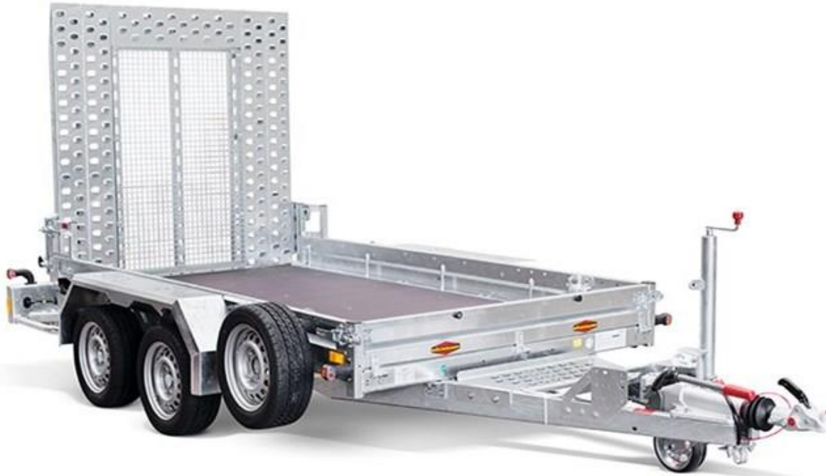
BT-ST 3518/35 AS, Stahlgitter zwischen Rampen, Ersatzrad mit Halter
