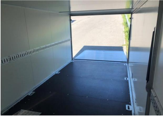
**2 x 5 Bindebügel am Boden**
