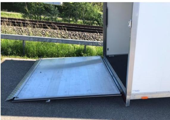
Rampe mit Überfahrblech am Rampenende
