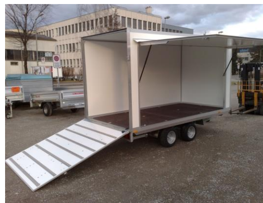
Hochlader mit Niederfahrwerk
